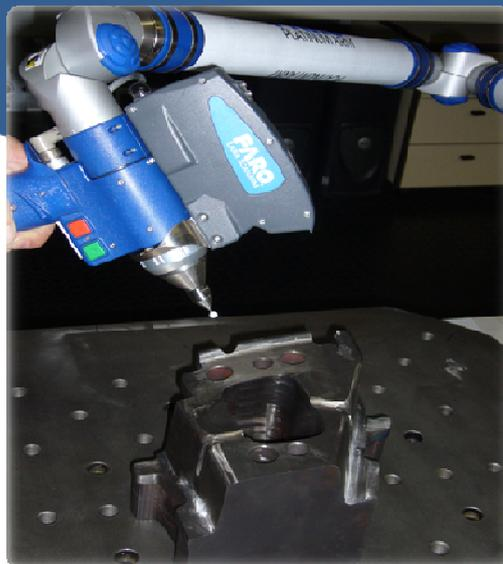
Réalisation de pièces de rechanges, numérisation des phases de mise au point.
